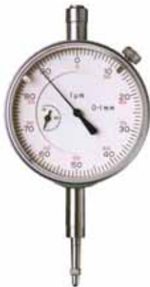
110-C001 千分表 Precision dial indicator 0-1mm x 0.001mm
